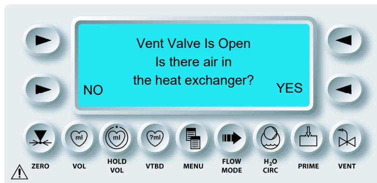
Wählen Sie **YES** (Ja), wenn sich Luft im Blasenabscheider des Wärmetauschers befindet. Die Konsole setzt den Fluss bei geöffnetem Entlüftungsventil fort. Der Benutzer hat die Option, die Funktion der automatischen Entlüftung zu deaktivieren. Auf korrekten Einbau des Induktionssets und Wärmetauschers überprüfen.
