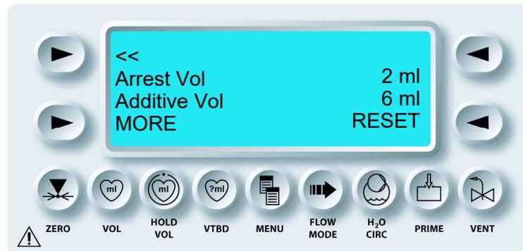
Um die induzierten Volumina „Ante Blood“ (Antegrad Blut), „Retro Blood“ (Retrograd Blut) und „Simulgrade Blood“ (Simulgrad Blut) aufzurufen, auf die Pfeiltaste **<MORE>** (<MEHR>) drücken.
