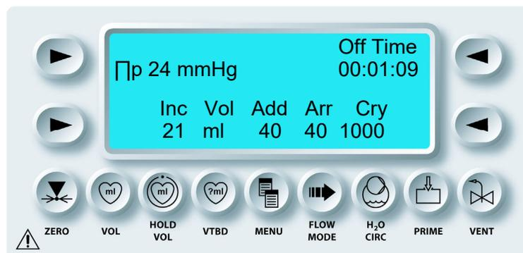
✓ DIE MPS-2-KONSOLE INDUZIERT DIE KARDIOPLEGIELÖSUNG IM ZYKLISCHEN MODUS, BIS DIE FLUSSRATE AUF NULL GESETZT WIRD ODER DER MODUS AUF NORMAL GEÄNDERT WIRD. IM ANSCHLUSS WIRD DIE INDUKTION IM NORMALEN MODUS FORTGESETZT. DER DRUCKPULS WIRD VOM AUSGEWÄHLTEN DRUCKSENSOR ANGEZEIGT UND DEM BENUTZER ANGEZEIGT.
