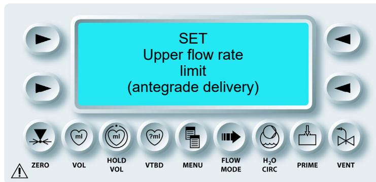
2. Mit dem Drehknopf für die Flussrate den oberen Grenzwert für die Flussrate einstellen (max. 999 ml/min.).
