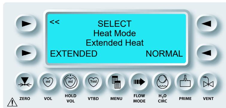
Im normalen Wärmemodus ist die maximal einstellbare Wärmtemperatur 39 °C. Im „Extended Heat Mode“ (Erhöhter Wärmemodus) ist die maximal einstellbare Wärmtemperatur 42 °C. Der Wärmemodus wird nicht gespeichert, wenn die MPS-2-Konsole ausgestellt wird, und der Fall wird fortgesetzt. Er wird auch nicht als Protokollparameter gespeichert.
