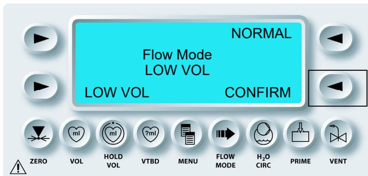
Nach dem Drücken von „CONFIRM“ (BESTÄTIGEN) kehrt die MPS-2-Konsole zum Bildschirm „RUN“ (AUSFÜHREN) zurück. Die MPS-2-Konsole pumpt dann mit einem reduzierten Durchsatzvolumen von 25 ml. Die maximale Flussrate liegt bei 200 ml/min und der „Low Volume indicator“ (Statusanzeiger Niedriges Volumen) wird auf dem Bildschirm „Run“ (Ausführen) angezeigt, wie auf der folgenden Seite dargestellt:
