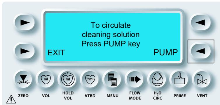
✓ DIE MPS-2-KONSOLE ZEIGT DEN ZEIGEBER DES REINIGUNGSZYKLUS AN UND LÄSST DIE REINIGUNGSLÖSUNG IM WARMWASSER- UND KALTWASSERKREISLAUF ZIRKULIEREN.
