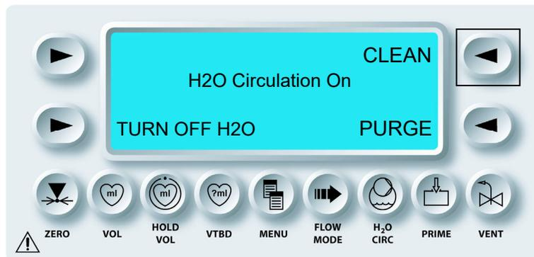
✓ DER BILDSCHIRM „CIRCULATE CLEANING SOLUTION“ (UMLAUF REINIGUNGSLÖSUNG) WIRD AUFGERUFEN.
