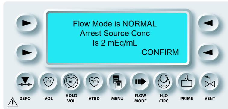
✓ DER ANWENDER WIRD ÜBER EINEN INFORMATIONSBILDSCHIRM ÜBER DEN FLUSSMODUS (NORMAL, NIEDRIGVOLUMEN ODER ZYKLISCH) UND DIE ÜBERNOMMENE KONZENTRATION DES HERZSTILLSTANDSMITTELS (2 mEq/mL) INFORMIERT. BEI AUSBLEIBENDER BESTÄTIGUNG WIRD DIESER BILDSCHIRM NACH EINIGER ZEIT GESCHLOSSEN.
