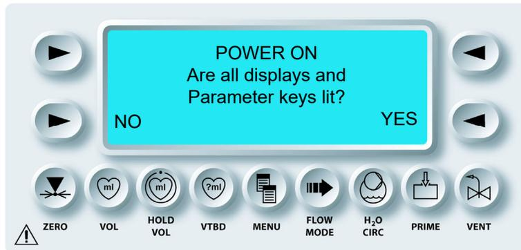
✓ WENN DER BEDIENER DIE PFEILTASTE **<NO>** (<NEIN>) DRÜCKT, WIRD VON DER MPS-2-KONSOLE EINE WARNMELDUNG AUSGEGEBEN. DURCH DRÜCKEN DER PFEILTASTE **<CONTINUE>** (<WEITER>) AUF DEM BILDSCHIRM KANN DER BEDIENER FORTFAHREN. DER BILDSCHIRM „SELECT OPTION“ (OPTIONS-AUSWAHL) WIRD AUFGERUFEN.
