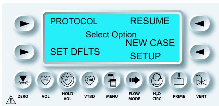
12. Drücken Sie bei angezeigter Meldung „POWER ON“ (EINSCHALTEN) die Funktionstaste „H2O circ“ (WASSERUMLAUF).
