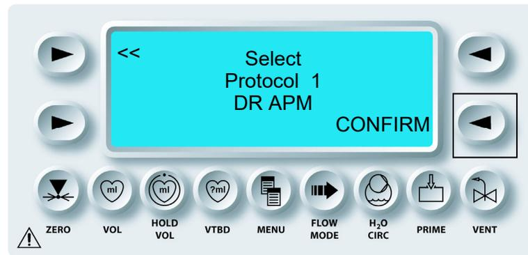
5. Der Drehknopf SET (EINSTELLUNGEN) wird verwendet, um durch die Liste der gespeicherten Protokolle zu scrollen. Wenn der Name für ein Protokoll gespeichert wurde, wird er angezeigt.
