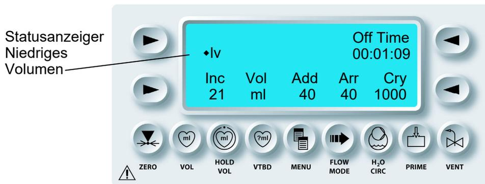
✓ DIE MPS-2-KONSOLE INDUZIERT DIE KARDIOPLEGIELÖSUNG IM MODUS FÜR NIEDRIGES VOLUMEN BIS DER FLUSSMODUS AUF NORMAL GEÄNDERT WIRD DURCH:
