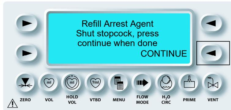
✓ Die MPS-2-KONSOLE BESTIMMT DAS VOLUMEN DER HERZSTILLSTANDSMITTELKASSETTE UND AKTUALISIERE DEN BILDSCHIRM „RUN“ (AUSFÜHREN).
