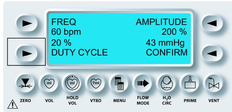
Der Arbeitszyklus wird in Prozent (%) angegeben. Er bestimmt, mit wie viel Prozent der Zyklus mit erhöhter (oberer) Flussrate arbeitet. Der Arbeitszyklus liegt zwischen 10 % und 50 %.
