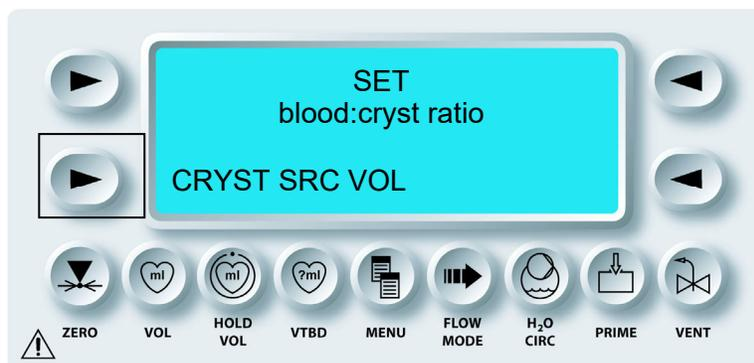
✓ DER BILDSCHIRM „SET CRYST SOURCE VOLUME“ (AUSGANGSVOLUMEN KRISTALLOID EINSTELLEN) WIRD ANGEZEIGT.
