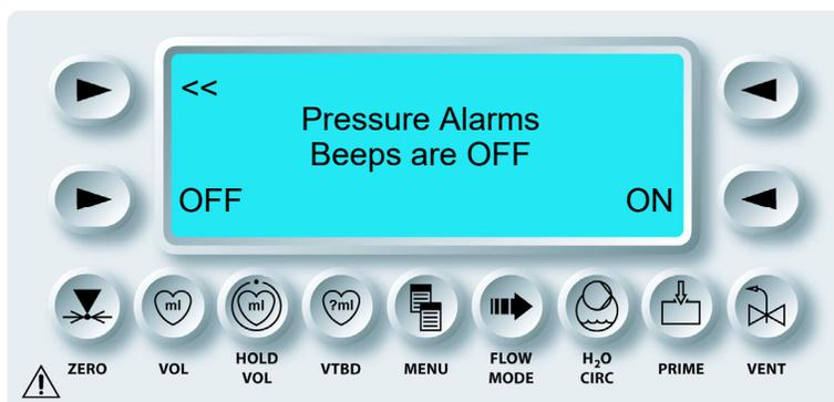
6. Um die Warnsignale Druck auf „ON“ (AN) zu stellen, auf die Pfeiltaste <ON> (<AN>) drücken.
