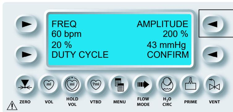
Die Amplitude wird in Prozent (%) angegeben. Die Amplitude bestimmt die Höhe der erhöhten (oberen Flussrate) für den Zeitraum des ersten Abschnitts des eingestellten Arbeitszyklus. Der Fluss übersteigt in diesem Abschnitt nicht 750 ml/min. Die MPS-2-Software wird dem Benutzer automatisch Amplituden empfohlen, die diese Grenzen nicht überschreiten. Der Bereich liegt zwischen 50 % und 300 %.
