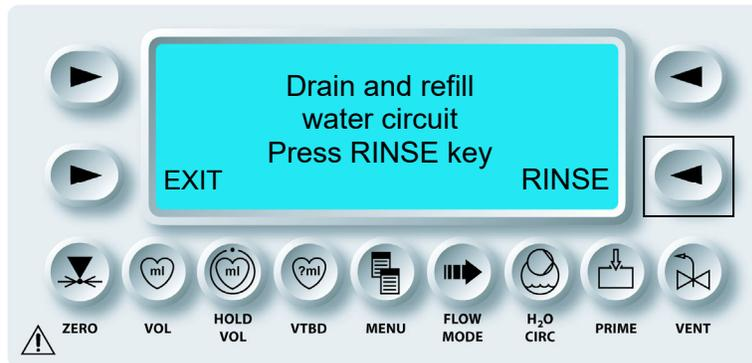
✓ DIE MPS-2-KONSOLE ZEIGT DEN ZEIGEBER DES SPÜLZYKLUS AN UND LÄSST DAS SPÜLWASSER IM WARMWASSER- UND KALTWASSERKREISLAUF ZIRKULIEREN.
