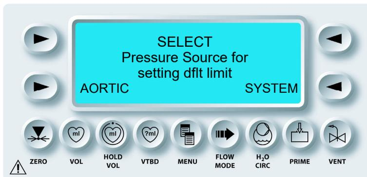
✓ *DER BILDSCHIRM „SET DEFAULT ANTEGRADE SYSTEM UPPER PRESSURE LIMIT“ (EINSTELLUNG OBERE STANDARDBEGRENZUNG DES ANTEGRADEN SYSTEMDRUCKS) WIRD ANGEZEIGT. DIE STATUSANZEIGEN FÜR DIE PARAMETERTASTE **<ANTE SET>** (**<ANTEGRADEINSTELLUNG>**) UND „SET“ (EINSTELLUNGEN) SIND AKTIVIERT. DER AKTUELLE WERT WIRD UNTER DER PARAMETERTASTE ANGEZEIGT.*
