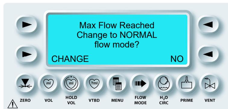
„MAX FLOW REACHED“ (MAX FLUSS ERREICHT), zum Flussmodus „NORMAL“ wechseln.
