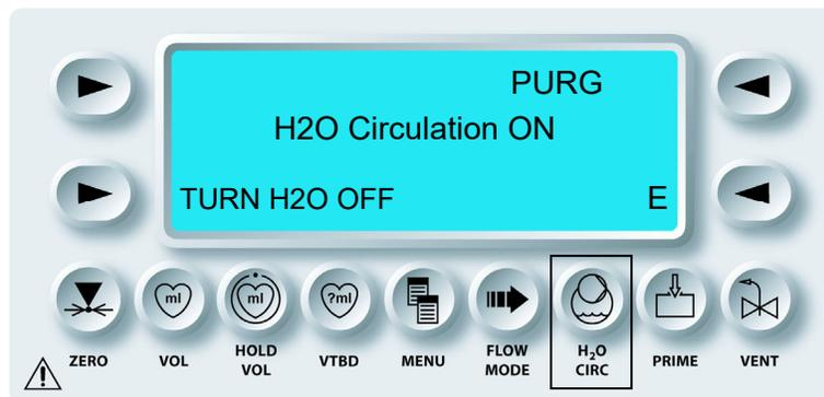
Damit wird die Wasserumlaufreinigung der MPS-2-Konsole abgeschlossen. Die MPS-2-Konsole kann nun für die Induktion vorbereitet oder abgestellt werden. Zur Vorbereitung der Induktion folgende Anleitungen für das Befüllen des Behälters und Spülen des Systems befolgen.
