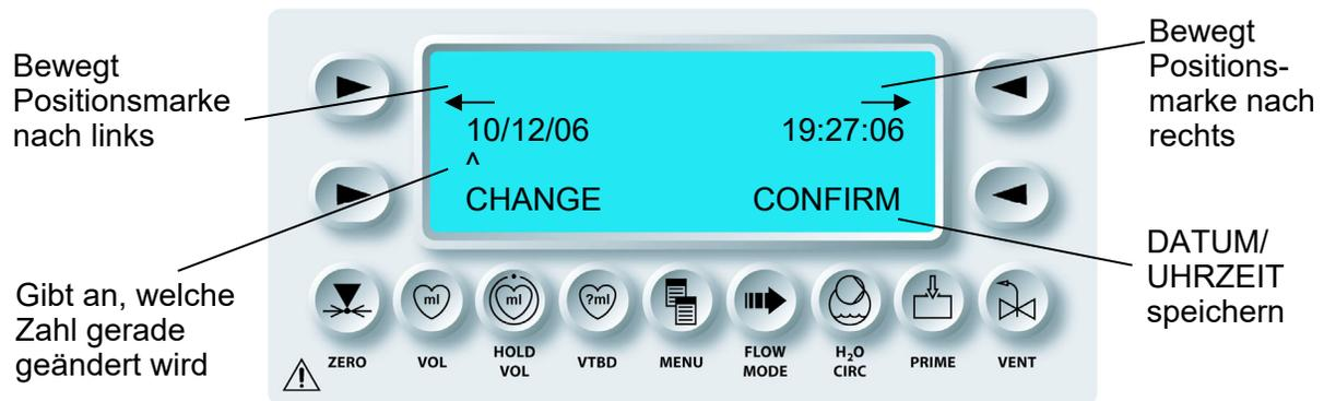
6. So ändern Sie Datum oder Uhrzeit: Durch Drücken der rechten Pfeiltaste die Positionsmarke nach rechts bewegen. Mit der linken Pfeiltaste die Positionsmarke nach links bewegen. Die Positionsmarke unter der zu ändernden Zahl positionieren.
