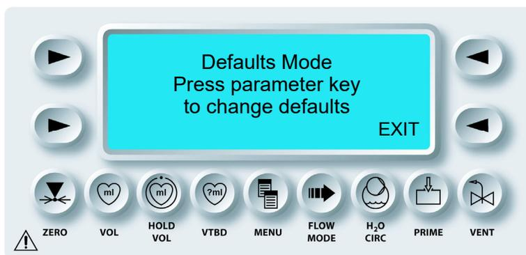
✓ DIE MPS-2-KONSOLE BEFINDET SICH IM STANDARDMODUS. ZUM EINSTELLEN EINES STANDARDPARAMETERS MUSS DER BEDIENER DIE ENTSPRECHENDE PARAMETERTASTE DRÜCKEN. AUF DEN FOLGENDEN SEITEN WIRD DER ABLAUF ZUM EINRICHTEN DER EINZELNEN STANDARDPARAMETER SCHRITT FÜR SCHRITT ERKLÄRT UND ILLUSTRIRT.
